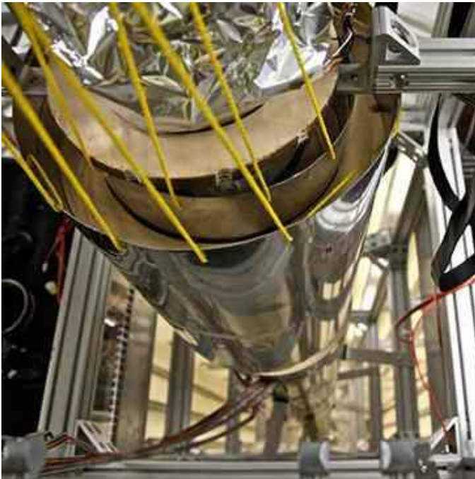
Rysunek . Tzw. fontanna atomowa widoczna na zdjęciu ma długość prawie 9 m. Dzięki zliczaniu drgań atomu cezu zegar atomowy odmierza czas z dokładnością wyższą niż jedna mikrosekunda na rok (Źródło: Steve Jurvetson)
