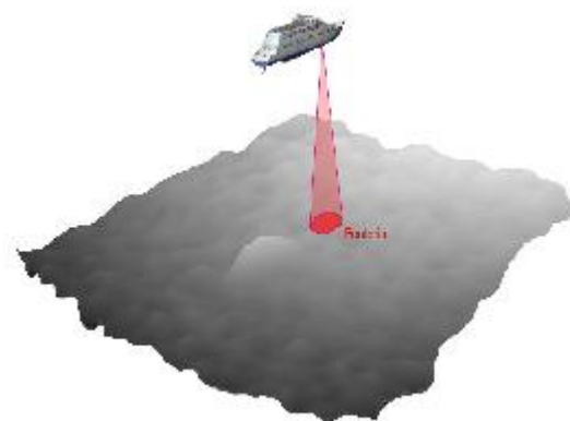
Rys.1 Wiązka akustyczna i jej ślad na dnie
